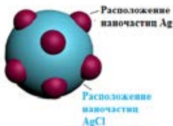
Рисунок 3 – Образование наночастиц серебра на поверхности хлорида серебра
